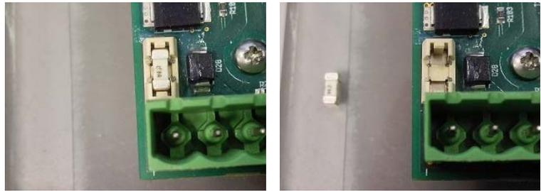
Die Ersatzsicherung aus ihrer Halterung nehmen und in die Halterung am Gerät einsetzen.
