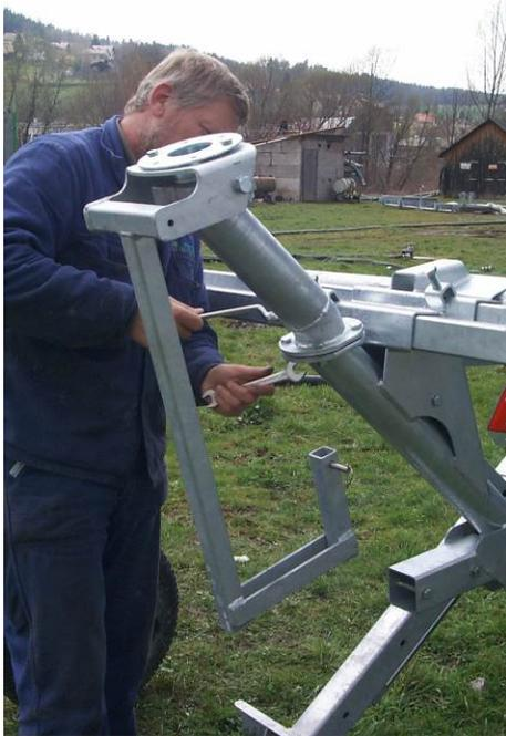
Regner Anschluss mit Pendel um 90° in die Betriebsposition drehen, Dichtung einlegen und wieder montieren.
