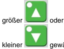
Die Geschwindigkeit ändert sich zuerst schrittweise um 0,1 m/h, dann tritt ein Wechsel nach zehn Schritten um 1,0 m/h ein.
