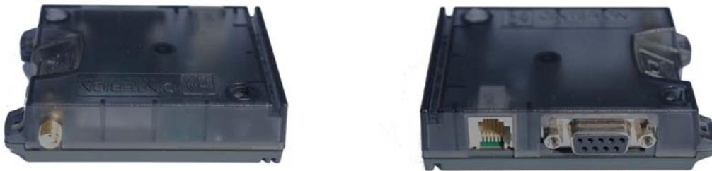
Das **BGS2T GSM Modem von Cinterion** verfügt über ein LED, das den Status anzeigt.
