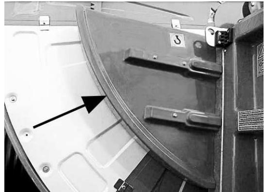
Feste Abdeckung zum Schutz des Ritzels, das dem Drehen des Drehkranzes dient.
