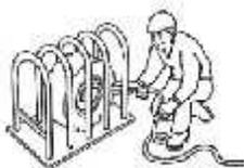
Das Aufpumpen muss in einem stabilen Sicherheitskäfig erfolgen, der im Fall von Problemen hinsichtlich der Dichtigkeit des Reifens, einen Schutz bieten kann.
