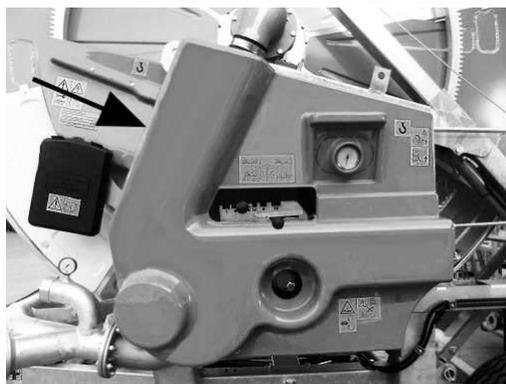
Feste Schutzvorrichtungen an den Seitenrändern der Trommel.
